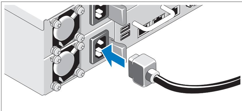
Conecte o(s) cabo(s) de alimentação ao sistema e, se for usado um monitor, conecte o(s) cabo(s) de alimentação ao monitor. Conecte a outra extremidade dos cabos de alimentação a uma tomada elétrica aterrada ou a uma fonte de alimentação separada, como uma fonte de alimentação ininterrupta ou a uma unidade de distribuição de energia.
