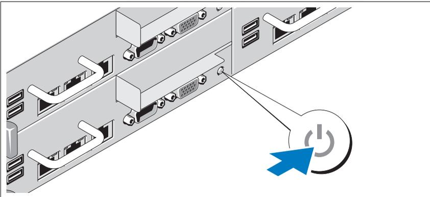
Appuyez sur les boutons d'alimentation à l'avant ou à l'arrière du système et du moniteur. Les voyants d'alimentation s'allument.
