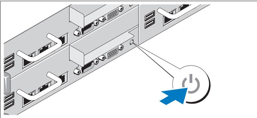
Pulse el botón de encendido de la parte frontal o posterior del sistema y el monitor. Los indicadores de alimentación deberían iluminarse.
